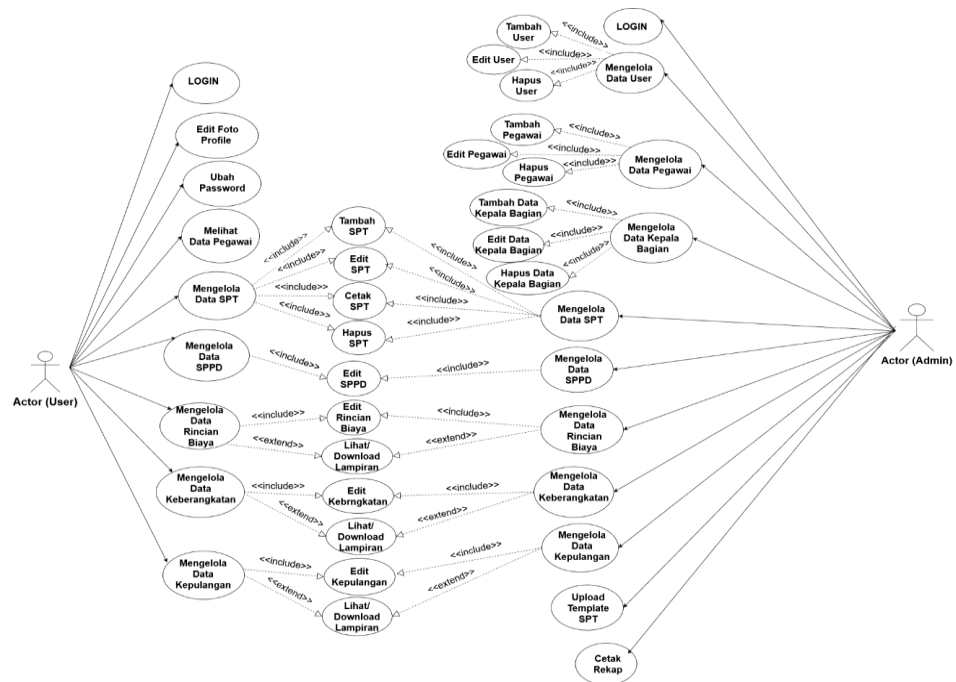
Gambar 2. Usecase Diagram Sistem Informasi SPPD
