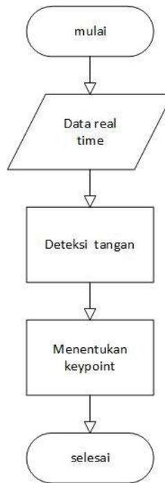
Gambar 1. Flowchart hand recognition dengan MediaPipe
