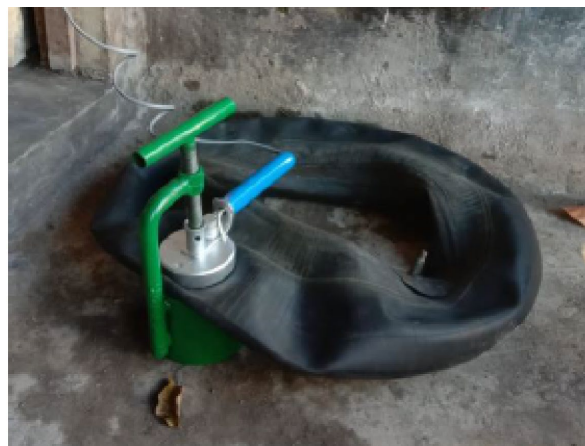
Gambar 3. Proses penambalan ban dalam
