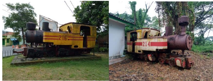
Gambar 1.6. Beberapa lokomotif uap bertipe mallet pabrikan DuCroo&Brauns milik PG Kunir ya saat ini berada di area PG Pesantren Baru (sumber : dokumentasi pribadi, 2022)
