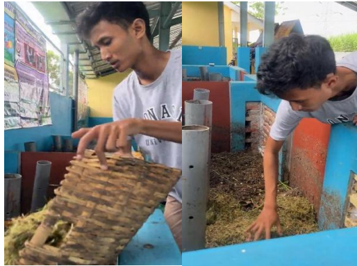
Gambar 5 Proses pematangan kompos pada sistem bata berongga
