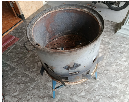
Gambar 3.4 Hasil Prototipe Sistem Bakar Drum Minim Asap
