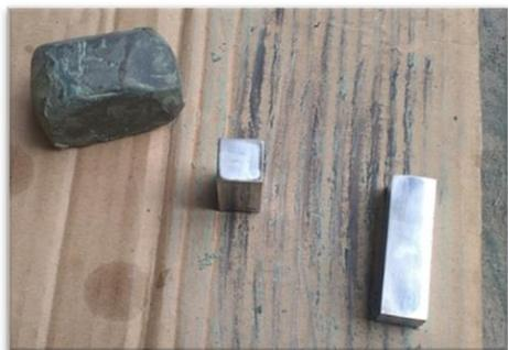
Gambar 2. Proses perempelasan dan pemolesan baja ST 60.
