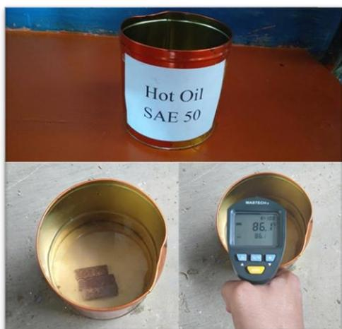
Gambar 5. Proses *quenching* pada baja sesudah dilakukan *heat treatment*.
