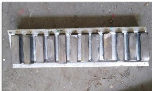
Gambar 6. Proses perempelasan dan pemolesan setelah dilakukannya proses *heat treatment* dan *quenching*.
