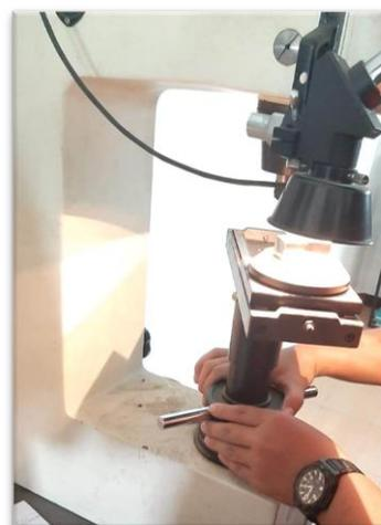
Gambar 7. Pengujian kekerasan pada baja setelah dilakukan proses *treatment* dan pembersihan.
