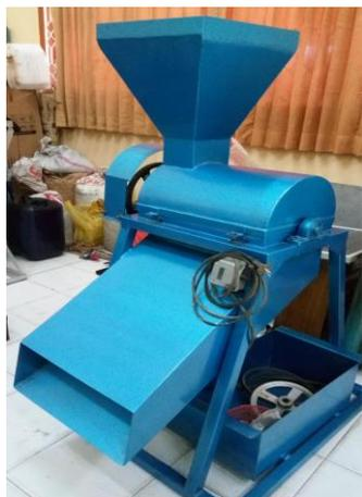
Gambar 6. Alat Pencacah Daun Kering
