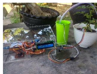
Gambar 8. Uji Soil Moisture dan DHT11
