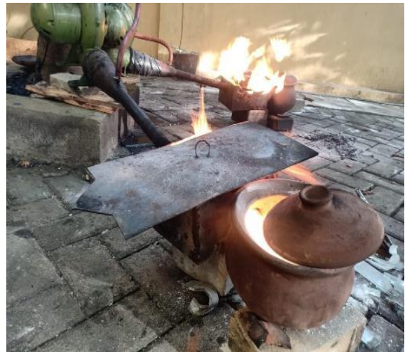
Gambar 3. Proses pelelehan limbah kaca
