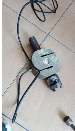
Gambar 3. Komponen Load Cell 100T
