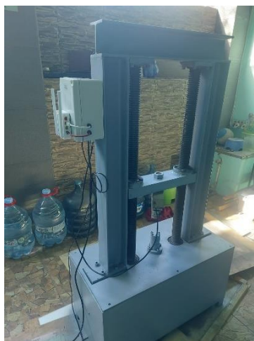
Gambar 2. Mesin Uji Tarik
