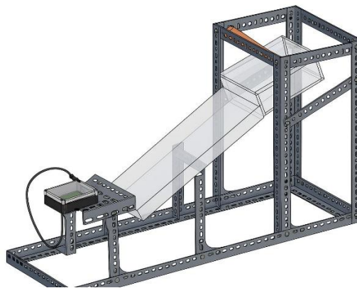
Gambar 3. Alat penghitung otomatis sensor infrared
