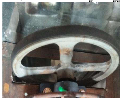
Gambar 7. Pully Atas Yang Sudah Terhubung Dengan Sabuk
