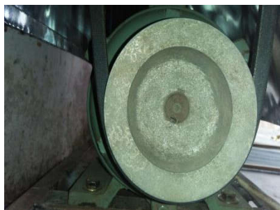
Gambar 8. Pully Bawah Yang Sudah Terhubung Dengan Sabuk
