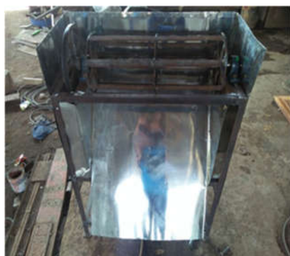
Gambar 2. Hasil Rancang Bangun Alat Perontok Kacang Tanah
