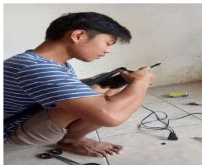
Gambar 3. Pemasangan gagang ke dinamo.
