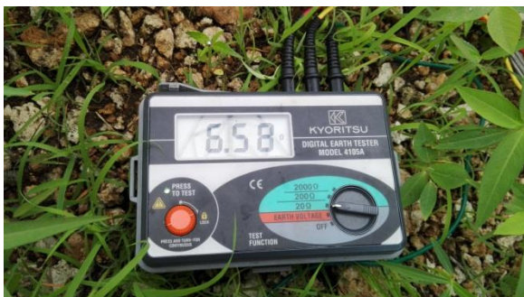
Gambar 1.5 Hasil Pengukuran Tower 70 Menggunakan Earth Tester Kyoritsu 4105A
