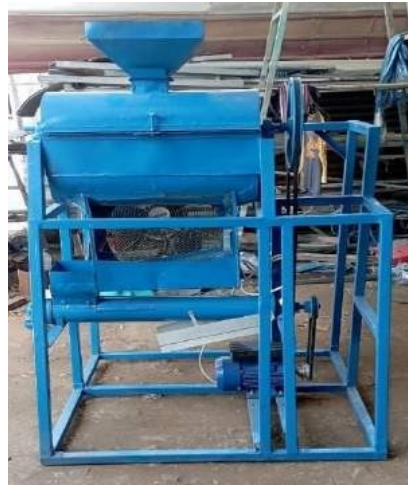
Gambar 6. Mesin Pengupas Kacang Kapasitas 30 Kg/Jam
