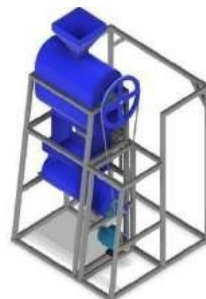
Gambar 2. Desain Mesin Pengupas Kapasitas 30 Kg/Jam
