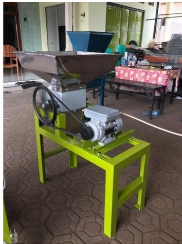
Gambar 3.4 Mesin Pencacah Kulit Ari Kacang kedelai
