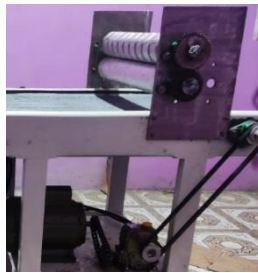
Gambar 1. Roller Pencetak Dan Gearbox Reducer
