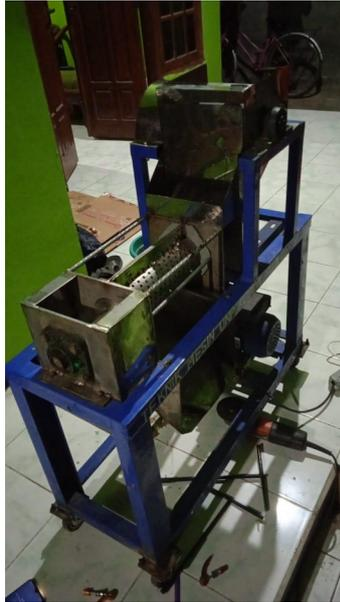
Gambar 1 Mesin Pamarut dan Pemas Kelapa
