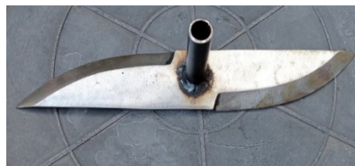
Gambar 4. Hasil jadi pisau pencacah rumput gajah kapasitas 50Kg/jam
