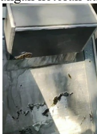
Gambar 15. Sieve Filter menyaring kotoran padat menggunakan mesh 100
