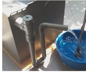
Gambar 16. Air dari sieve filter mengalir melewati UV reaktor
