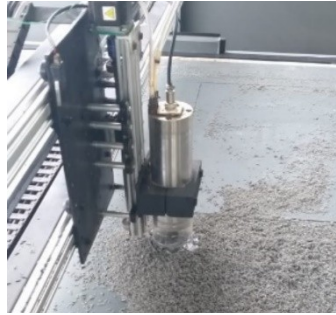
Gambar 12. Proses pemotongan PVC board menggunakan mesin CNC router
