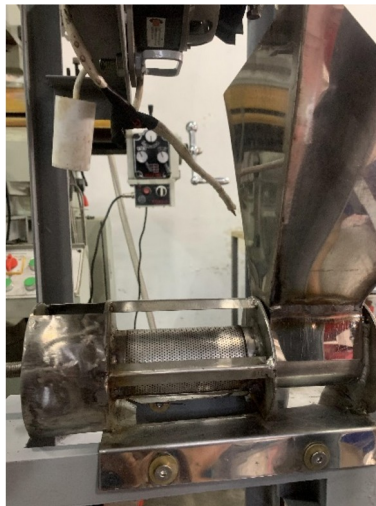
Gambar 3.4 Hasil Perancangan Alat Pemas Jahe
