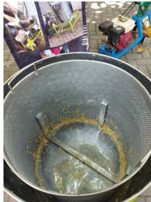
Gambar 4 Tabung Pengering (tabung dalam)
