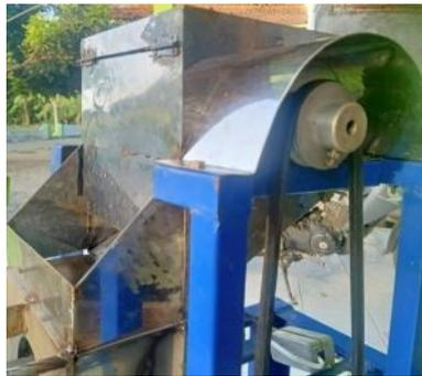
Gambar 4. Mesin pamarut kelapa kapasitas 20 Kg/Jam
