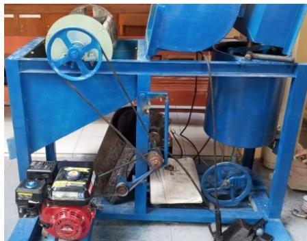
Gambar 3.2 Pulley dan v-belt yang di gunakan
