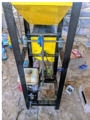
Gambar 3. Mesin Pengolah Kompos Kapasitas 5 Kg/Jam
