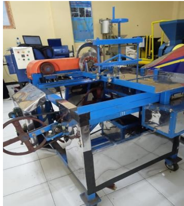
Gambar 2 Mesin Perajang Lontongan Kerupuk Kapasitas 50kg/jam
