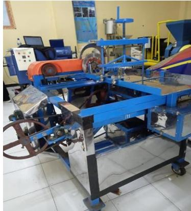
Gambar 2 Mesin Perajang Lontongan Kerupuk Kapasitas 50kg/jam
