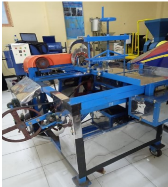
Gambar 2 Mesin Perajang Lontongan Kerupuk Kapasitas 50kg/jam
