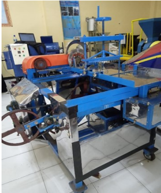
Gambar 2 Mesin Perajang Lontongan Kerupuk Kapasitas 50kg/jam
