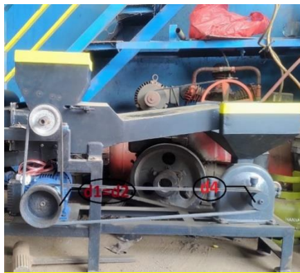
Gambar 1 Pulleymotor penggerak peng halus kulit kacang tanah
