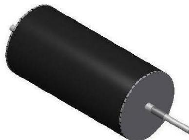
Roller drum berfungsi untuk memperoleh momen inersia dari hasil putaran roller yang terhubung langsung oleh mesin sebagai sumber tenaga penggerak dari roller drum.
