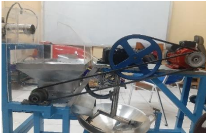
Gambar 2 Mesin Pamarut Nanas Kapasitas 2.5kg/jam
