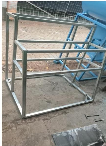
Gambar 3. Kerangka mesin pengupas
