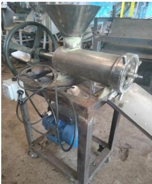
Gambar 3.1 hasil perancangan Spesifikasi alat pembuat tahu bulat dengan sistem ulir
