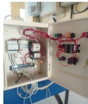
Gambar 3 Rangkain kelistrikan furnace
