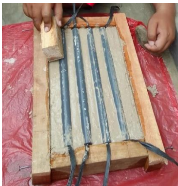
Gambar 3.2 Pembuatan Countur Tempat Pemanas
