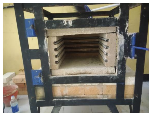
Gambar 3.6 Penyusunan Tumpuan Kawat Nikelin Ke Rangka Furnace
