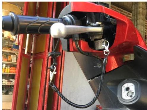
Gambar 9. Penempatan *emergency switch*
