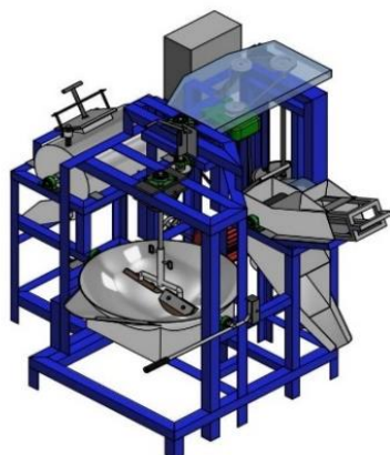
Gambar 2. 2 Alat keseluruhan Pengaduk Jahe Kristal
