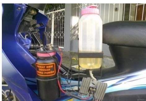
Gambar 3. Hasil pembuatan alat penghemat BBM Hidro Power dan pemasangan pada sepeda motor
