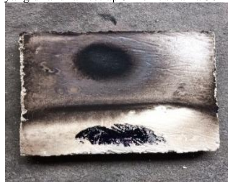
Gambar 4. Keramik alumina bagian dalam setelah dilakukan pembakaran
