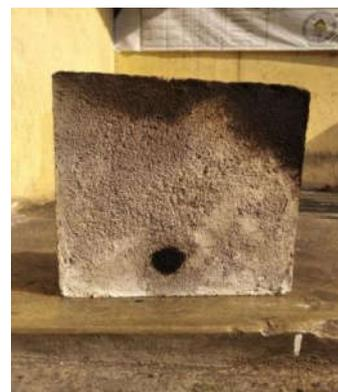
Gambar 4. Hasil pembakaran beton ketebalan 5cm
