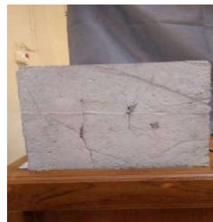
Gambar 2. Gambar beton ketebalan 5cm sebelum diuji kekuatan beton terhadap panas api secara langsung.
