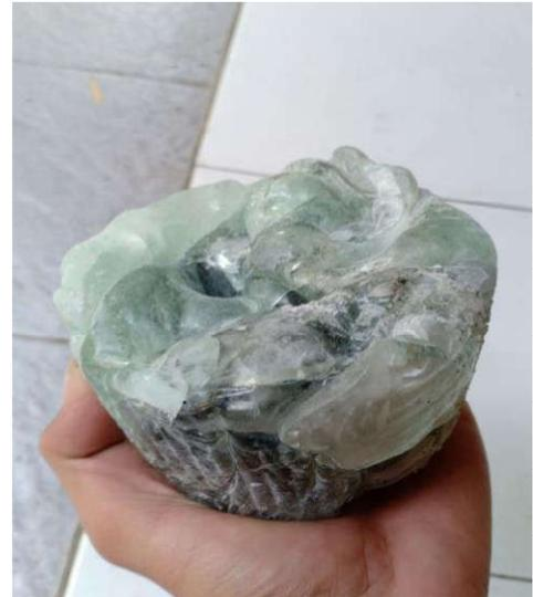
Gambar 4. Pelelehan limbah kaca dengan feldspar 20%
