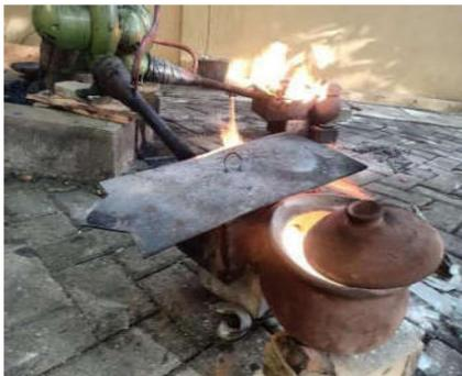
Gambar 2. Pelelehan limbah kaca dengan feldspar
