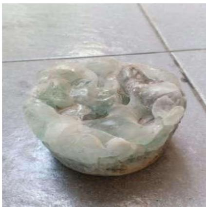
Gambar 3. Pelelehan limbah kaca dengan feldspar 10%
