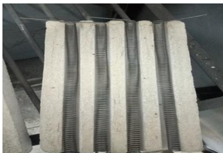
Gambar 9. Merangkai kawat nikelin pada tatakan
