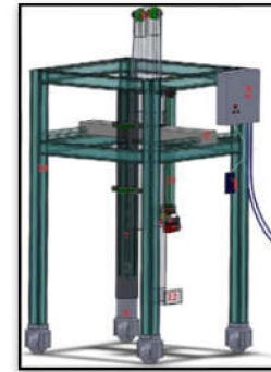
Gambar 5. Alat Pematat Tanah Uji Geosintetis Menggunakan Sistem Pneumatik Kontrol Plc [3]
