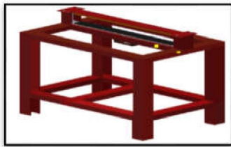
Gambar 3. Mesin Press Dan Potong Kantong Plastik Dengan Penggerak Pneumatik [2]
