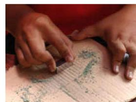
Gambar 2. Proses perampelasan dan pemolesan baja ST 60
