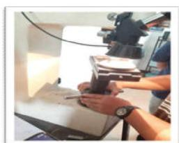
Gambar 7. Pengujian kekerasan pada baja setelah dilakukan proses *treatment* dan pembersihan
