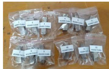
Gambar 8. Hasil baja yang telah dilakukan proses *treatment*
