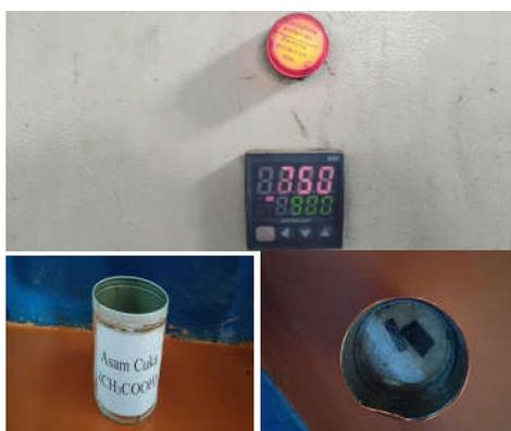
Gambar 5. Proses *quenching* pada baja
