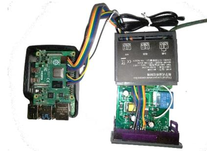
Gambar 6. Rangkaian Sensor NTC 10 K
