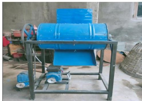
Gambar 4. Mesin Pencampur Ragi Dan Ampas Tahu
