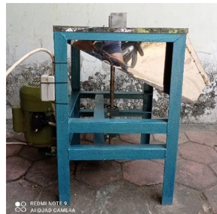
Gambar 3. Mesin pengiris pisang
