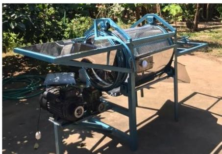
Gambar 5. Mesin pencuci pisang
