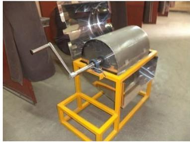
Gambar 1. Mesin Cuci Bengkuang Dengan Sistem Silinder Berputar[2]
